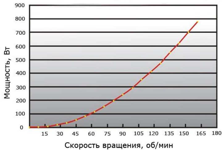
График зависимости мощности ветрогенератора «ВГ500» (Вт) от частоты вращения (об/мин)
